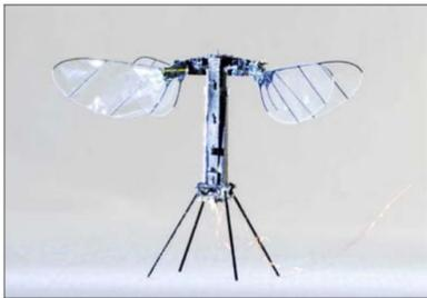
El pequeño RoboBee X-Wing vuela batiendo las cuatro alas y gracias a la energía de celdas solares.
